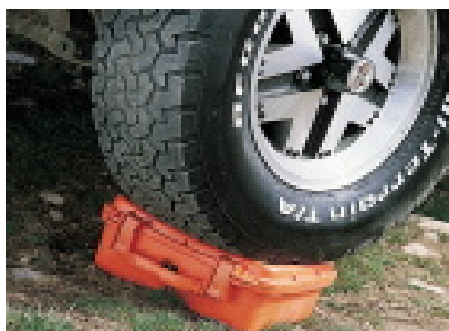
图 2-4-1 箱体抗压试验
