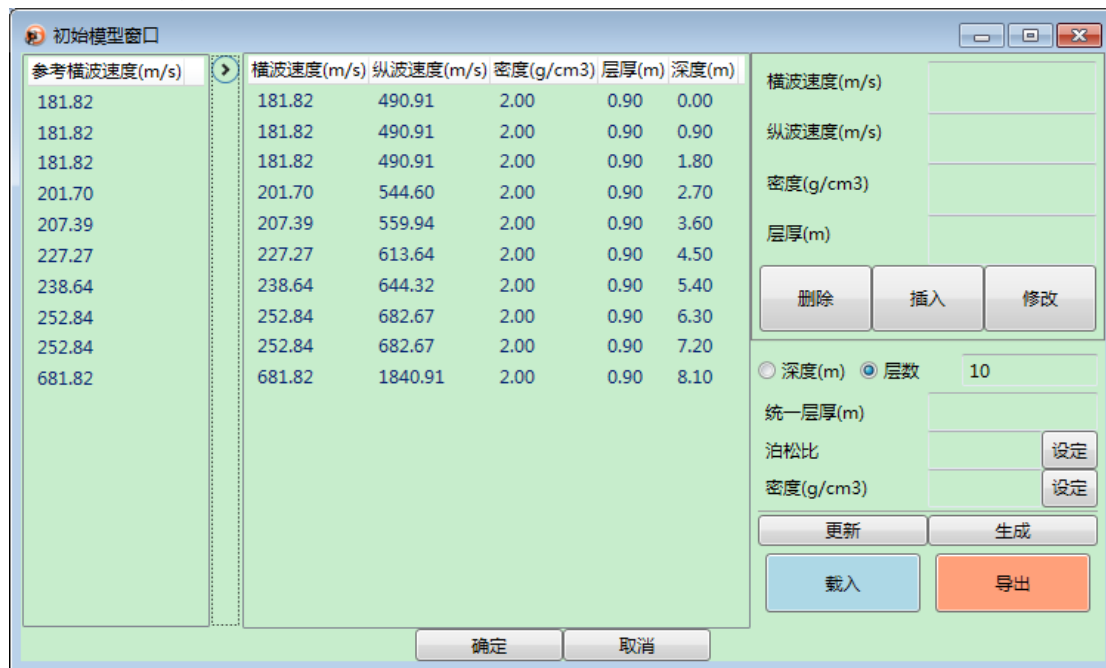
图 7-2 反演初始模型设计对话框
